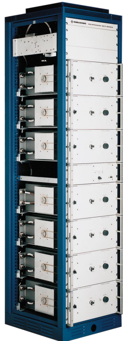
UHF 7-Port Multicoupler FD225W7 (Photo 37808)
